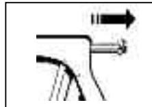
2. Colocar la cápsula de aplicación cerrada después de la aplicación y proceso de mezcla efectuado en el aplicador y empujar cuidadosamente el cierre mandril hacia adelante, hasta que el punzón dé en la parte superior de la cápsula.
