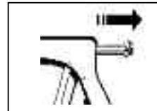
2. Die ungeöffnete Applikationskapsel nach Aktivierung und erfolgtem Mischvorgang in den Applikator einlegen und den Kolben vorsichtig etwas nach vorn schieben, bis der Kolben an die Kapselrückwand anstößt.
