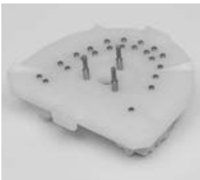
3 Pins in Modellplatte stecken.
